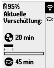
Sie ersehen die Verschüttungsdauer in Stunden und Minuten sowie die Zeitdauer innerhalb der Verschüttungsdauer, in welcher Vitaldaten des Verschütteten gemessen werden konnten. Die Anzeige der Verschüttungsdauer wird auch dann aktiviert, wenn das Barryvox® ausserhalb einer Lawine zum Stillstand kommt.
