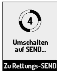
Das Gerät wechselt nach 4 Sekunden automatisch in den SEND Modus.
