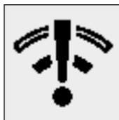
Bemerkt das Gerät, dass die SEND Funktion beeinträchtigt ist, blinkt die SEND Kontrollleuchte nicht mehr und die SEND Anzeige warnt den Benutzer mittels Ausrufezeichen.
