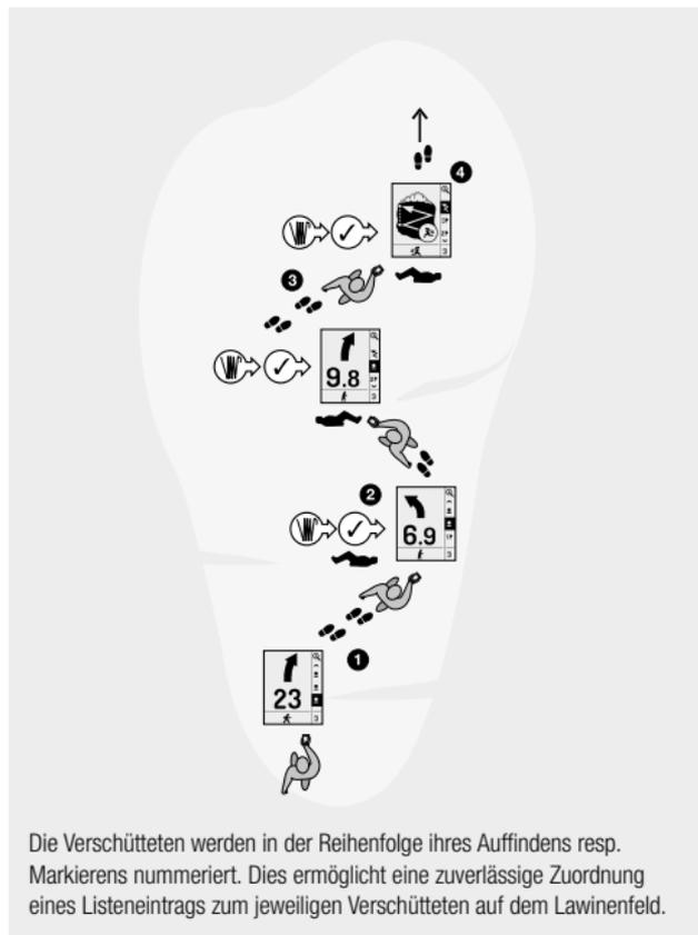
Die Verschütteten werden in der Reihenfolge ihres Auffindens resp. Markierens nummeriert. Dies ermöglicht eine zuverlässige Zuordnung eines Listeneintrags zum jeweiligen Verschütteten auf dem Lawinengebiet.
