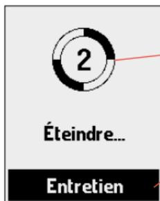
L'appareil s'éteint 2 secondes après la commutation de l'interrupteur principal en position OFF.
