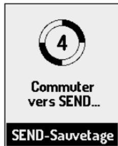
Après 4 secondes, l'appareil commute automatiquement en mode SEND.
