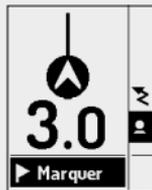
Lors de cette phase de recherche, tenez le DVA à hauteur des genoux! L'appareil vous guide dans une recherche en croix systématique jusqu'au point où la recherche sera plus rapide et efficace avec une sonde.
