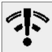
Si l'appareil détecte un problème avec la fonction SEND, la LED rouge de contrôle SEND cesse de clignoter et un symbole d'avertissement s'affiche.
