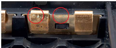
Contact de la pile avec des signes évidents de fuite de la pile, ce qui nécessite son remplacement.
