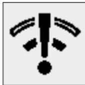
Se l'apparecchio rileva che la funzione SEND è compromessa, il LED di controllo rosso smette di lampeggiare e l'indicazione SEND sul display mostra un segnale di avviso.
