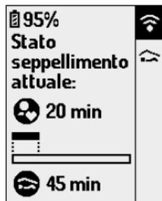
La durata del seppellimento viene visualizzata in ore e minuti insieme al periodo di tempo durante il quale sono stati rilevati i dati vitali. La visualizzazione della durata del seppellimento viene attivata anche nel caso in cui il suo Barryvox®S smette di muoversi all'esterno di una valanga.
