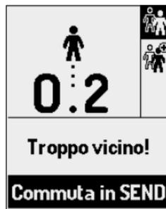
In caso il normale test di gruppo non sia possibile a causa dello spazio limitato, è possibile eseguire una verifica che gli apparecchi di tutti i partecipanti siano accesi.
