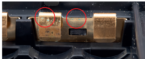
Styk baterii z wyraźnymi oznakami wycieku z baterii, konieczna wymiana styku.
