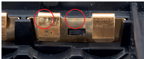
Baterijski kontakt v ležišču baterij, kjer se jasno vidi korozija in slab stik z baterijo. Takšen kontakt mora biti nujno tovarniško zamenjan.
