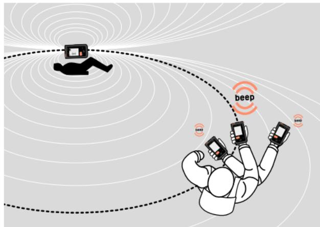
Para optimizar el alcance, pivote lentamente el dispositivo DVA sobre todos sus ejes. Sujete el dispositivo con el altavoz hacia su oreja, junto a su cabeza.
