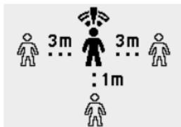
Si su Barryvox®S detecta que la frecuencia de transmisión de un dispositivo testeado está fuera de los límites de tolerancia aceptables, se mostrará un mensaje de advertencia. En ese caso, repita el test con una separación entre los participantes de 5 m para identificar cuál es el dispositivo defectuoso. Dicho dispositivo debe ser enviado y revisados por el fabricante.
