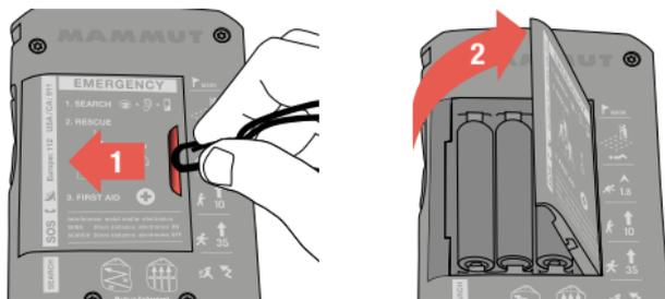
Utilice la uña del dedo o el clip de la correa para deslizar la tapa del compartimento de las baterías hacia la izquierda y abatirla.
