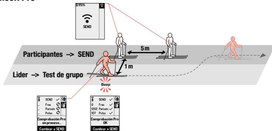
El “Check Pro” analiza parámetros adicionales del dispositivo testeado y los muestra. En caso de que uno de los parámetros medidos esté fuera de los límites tolerables, se muestra una alerta para ese parámetro en concreto. Se recomienda especialmente llegar a cabo el Check-pro de dispositivos antiguos de 1 y 2 antenas, y en general para todos aquellos dispositivos que no han sido verificados por el fabricante en un largo periodo de tiempo.
