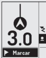
Durante esta fase de la búsqueda, ¡sujete el dispositivo a la altura de la rodilla! Usted será guiado a través de un patrón de búsqueda sistemático en forma de cruz hasta el punto donde la búsqueda sea más rápida y eficaz con una sonda.
