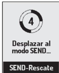
Después de 4 segundos, el dispositivo cambia de forma automática a modo SEND.
