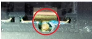
Un resorte de presión individual contaminado. En comparación con los contactos de presión dobles, los de tipo individual solo pueden ser reemplazados si el conector principal de energía que existe detrás no está contaminado
