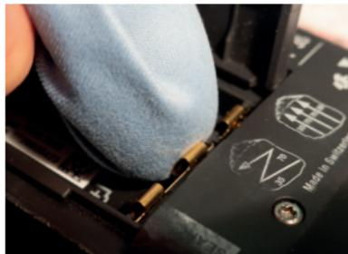
para que el resorte ceda y vuelva de nuevo a su posición original. Limpie los contactos de uno en uno. En particular, después de la limpieza compruebe que los contactos de las baterías quedan en la posición correcta. El contacto está correctamente insertado lateralmente en los rieles de guía y en la parte superior bloqueado por el botón de bloqueo.
