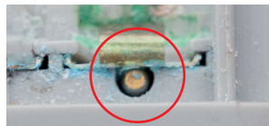
Kontaminovaný hlavní konektor baterie
