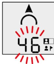
Wird das Signal des Verschütteten welches Sie derzeit suchen kurzzeitig von Signal eines anderen Verschütteten überlagert, versucht das Gerät Sie so lange wie möglich auf dem optimalen Suchweg zu führen. Bei besonders langandauernden Signalüberlagerungen ist eine zuverlässige Führung nur begrenzt möglich. Das Gerät zeigt dies durch eine blinkende Distanzanzeige an. Verlangsamen Sie die Suche stark, bis die Distanzwerte wieder konstant angezeigt werden.
