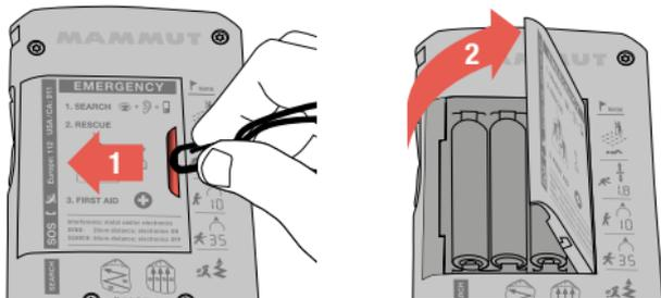
Verwenden Sie einen Fingernagel oder den Haken der BarryLeash um den Batteriefachdeckel nach links zu schieben, sodann klappt er auf.
