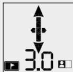
Führen Sie das Gerät in dieser Phase auf Kniehöhe. Das Barryvox zeigt Ihnen die erste Achse der Feinsuche, welche im Ausbildungsmodell des „Airport Approach“ als „Landebahn“ bezeichnet wird. Für Anfänger ist es normalerweise schneller nach dem Auffinden der kleinsten Distanzanzeige auf der ersten Achse direkt zur Anwendung der Sondierspirale in der Punktortung zu gehen.
