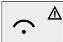
Bemerkt das Gerät dass die SEND Funktion beeinträchtigt ist, blinkt die SEND Kontrollleuchte nicht mehr und der Bildschirm zeigt eine Alarmmeldung.
