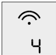
Das Gerät wechselt nach 4 Sekunden automatisch in den SEND Modus.
