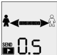
Die angezeigte Testdistanz darf nicht unterschritten werden, da der Gruppentest dadurch unzuverlässig wird.
