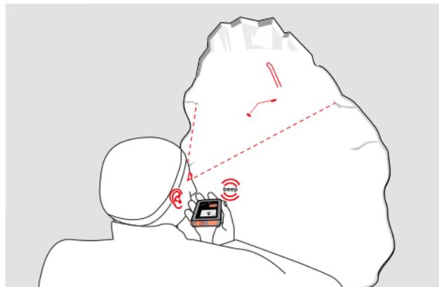
Der Lawinenkegel wird systematisch abgesucht, bis ein Sendesignal detektiert werden kann. Während der akustischen Signalsuche konzentriert sich der Retter visuell auf das Lawinenfeld, um sichtbare Objekte zu erkennen.
