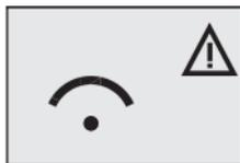
Se il test è riuscito, è confermato dal lampeggiamento del LED di controllo SEND rosso. Se l'apparecchio rileva che la funzione SEND è compromessa, il LED di controllo rosso smette di lampeggiare e l'indicazione SEND sul display mostra un segnale di avviso.
