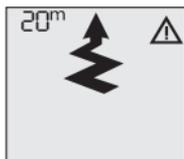
Ampiezza della fascia di ricerca del segnale diminuita a causa di un elevato numero di sepolti, vecchi trasmettitori con durata dell'impulso molto lunga o dispositivi che trasmettono al di fuori della frequenza standard.
