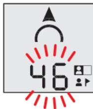
Se il segnale del sepolto che sta attualmente cercando si sovrappone ad un altro segnale, l'apparecchio prova a guidarla sul cammino ottimale. Se il segnale si sovrappone per un lungo periodo di tempo, la guida affidabile è limitata. L'apparecchio lo indica con un'indicazione della distanza ad intermittenza. Rallenti radicalmente la ricerca fino a che l'indicazione di distanza smetta l'intermittenza, indicando che la sovrapposizione si è eliminata.
