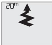
Ampiezza della fascia di ricerca del primo segnale diminuita a causa di un apparecchio che non trasmette con la frequenza standard.
