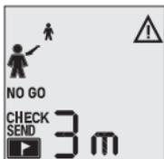
Se il suo Barryvox® rileva che la frequenza di trasmissione dell'apparecchio testato non rientra nella tolleranza, verrà visualizzato un messaggio di avviso. Gli apparecchi difettosi devono essere controllati dal produttore.
