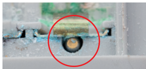
En forurenset hovedbatterikontakt
