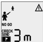
Si su Barryvox® detecta que la frecuencia de transmisión de un dispositivo testeado está fuera de los límites de tolerancia aceptables, se mostrará un mensaje de advertencia. En ese caso, repita el test con una separación entre los participantes de 5 m para identificar cuál es el dispositivo defectuoso. Dicho dispositivo debe ser enviado y revisados por el fabricante.
