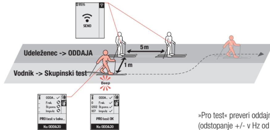
»Pro test« prepozna oddajno frekvenco naprave, ki je izven predpisanih vrednosti. Posebej priporočamo uporabo »Pro test« pri testiranju starejših 1 in 2 antenskih naprav ter na splošno pri napravah, ki dlje časa niso bile tovarniško testirane. »Pro test« vključimo v »Pro nastavitev« (Glej poglavje »Pro nastavitev«).
