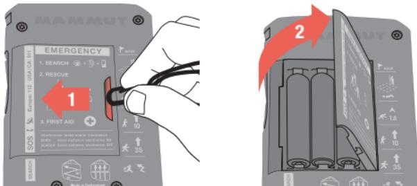
Uporabite noht na prstu, da premaknete zatič vratic proti levi in vrata se bodo odprla.
