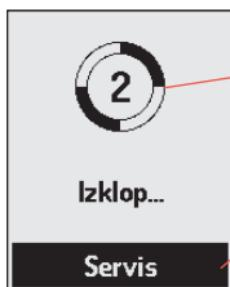
Naprava se bo izklučila po 2 sekundah, ko boste premaknili glavno stikalo na IZKLOP.
