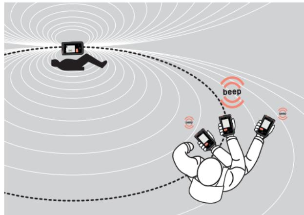
Za optimizacijo dosega rotirajte z napravo v vseh treh oseh. Napravo z zvočnikom proti ušesu držite blizu glave.
