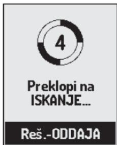
Po 4 sek. se naprava avtomatsko preklopi na način ODDAJA.
