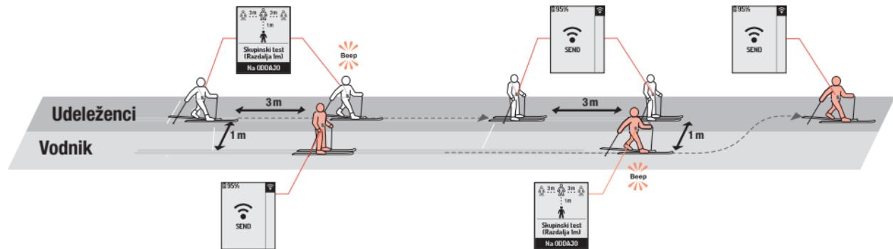
Priporočamo, da opravite dvosmerni, skupinski test vsaj enkrat tedensko oziroma vedno, ko se formira nova skupina. Dvosmerni, skupinski test preveri **ODDAJO** in **ISKANJE** na vseh napravah. Vsak udeleženec vključi funkcijo "skupinski test" ali nastavi napravo na (sprejem) na nizko občutljivost. Vodnik vključi svojo napravo na **ODDAJA** in se prepriča, da vsak udeleženec zazna njegov signal.
