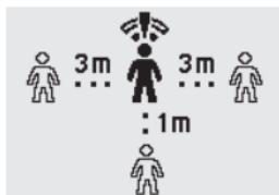
Če bo med preizkusom vaša Barryvox®S naprava zaznala, da frekvenca oddajne naprave ni v območju dovoljene, bo to prikazano na ekranu. V tem primeru ponovite test z razmakom udeležencev 3m in ugotovite, katera naprava oddaja napačno frekvenco. To napravo mora pregledati proizvajalec.
