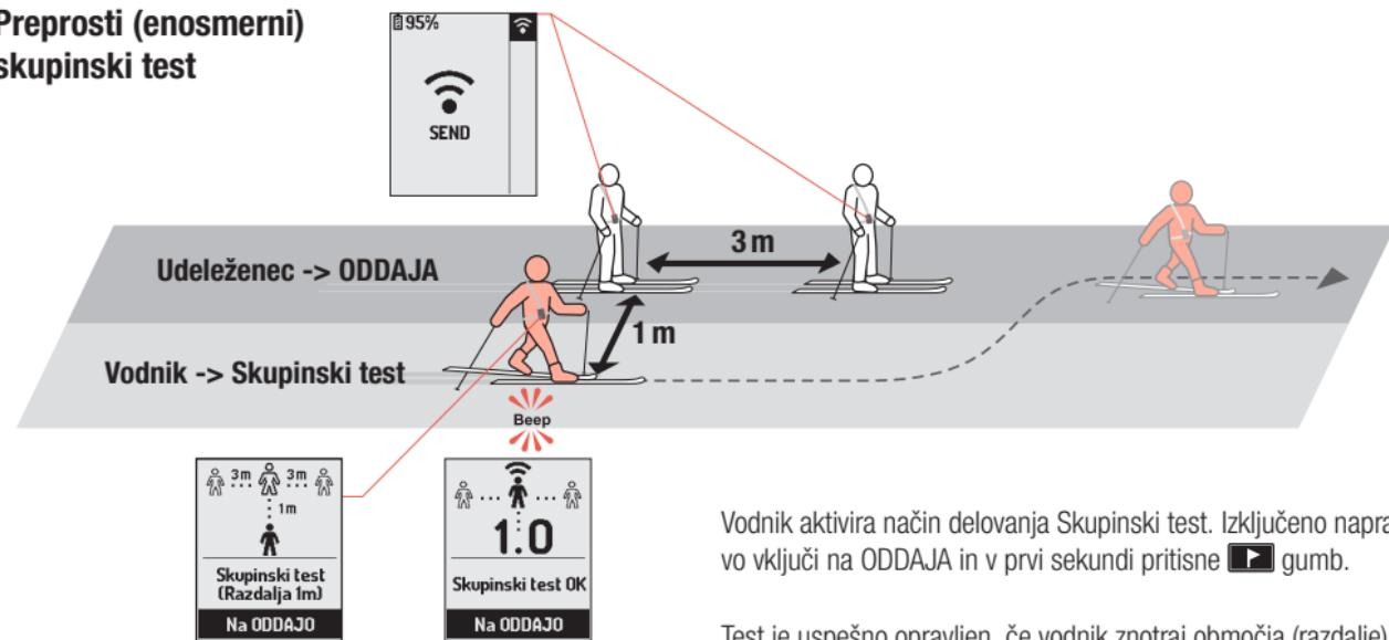
Vodnik aktivira način delovanja Skupinski test. Izključeno napravo vključi na ODDAJA in v prvi sekundi pritisne gumb.
