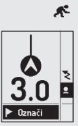
Na točki, kjer naprava pokaže začetek špiralnega sondiranja bo na zaslonu prikazana najmanjša razdalja. Večja, ko je razdalja do zasutega (globina zasutja), več ponovitev križnih iskanj bo potrebno, da boste dosegli najboljši rezultat. Naprava vodi reševalca skozi križno iskanje in sproti določa vrednosti, dokler ne dosežemo najboljšega rezultata in lahko začnemo s sondiranjem. Ta točka je na zaslonu prikazana s simbolom za sondiranje.
